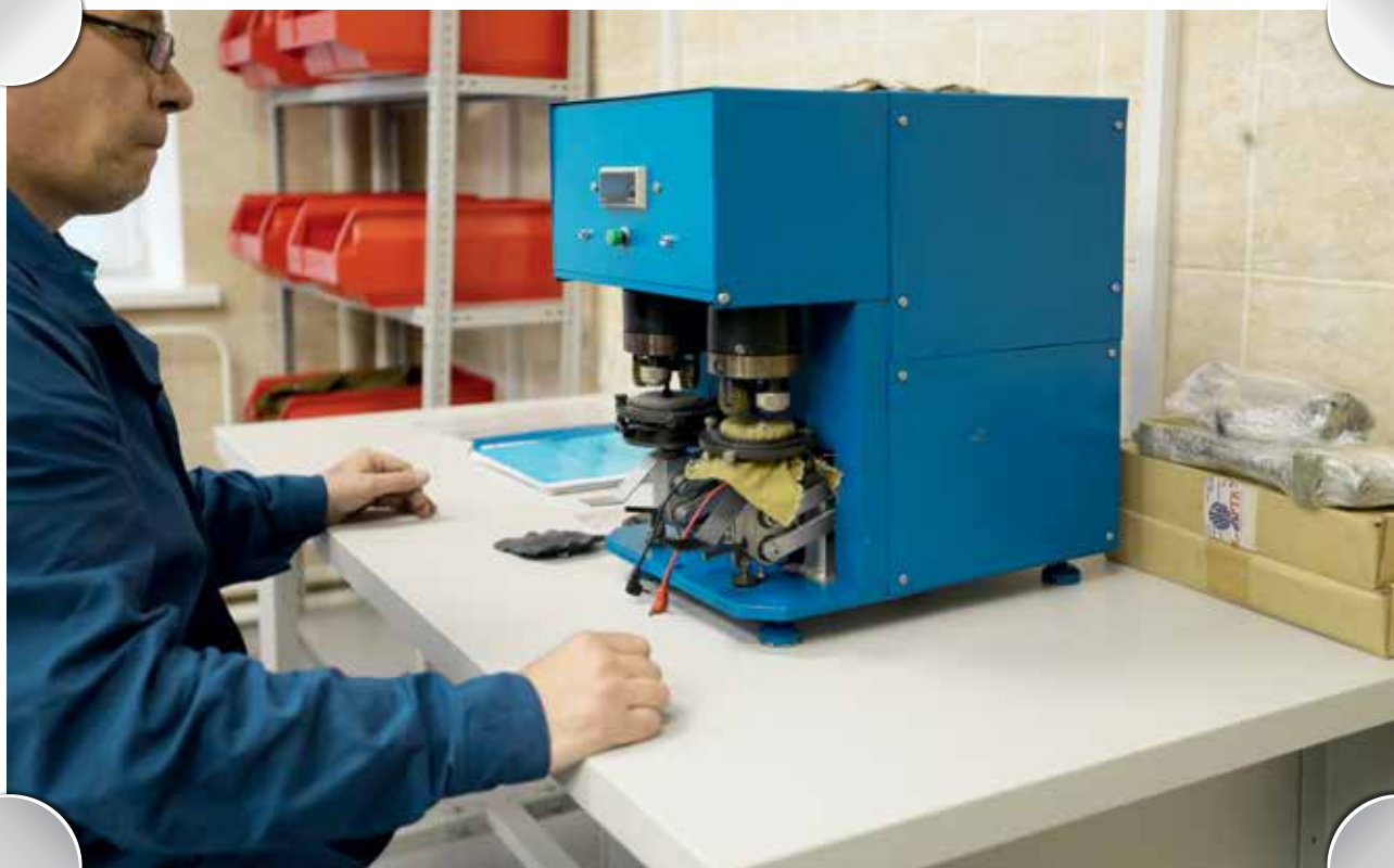
14 мая 2016 г. Проверка образцов СИЗ на истирание
