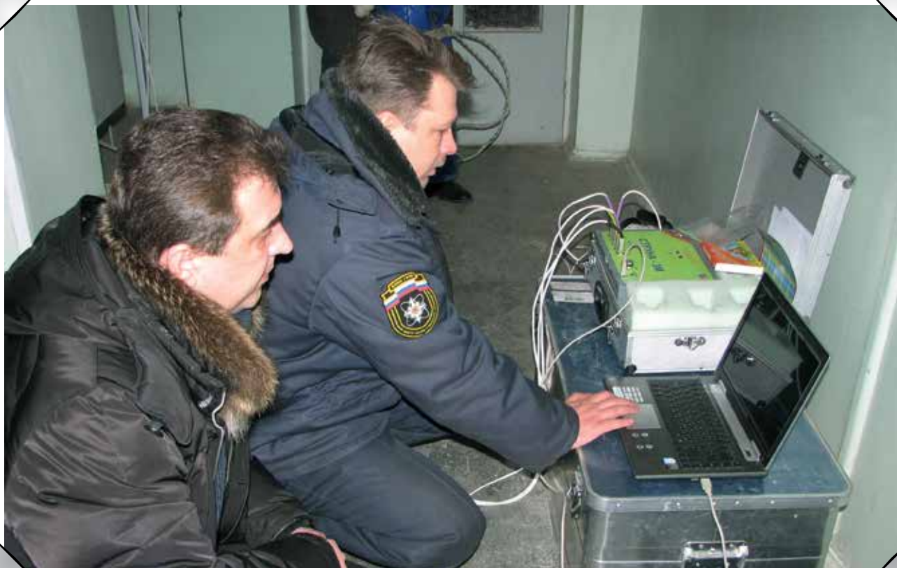
19 февраля 2009 г. Работы в Италии по снятию динамических параметров зданий с помощью комплекса «Струна»
